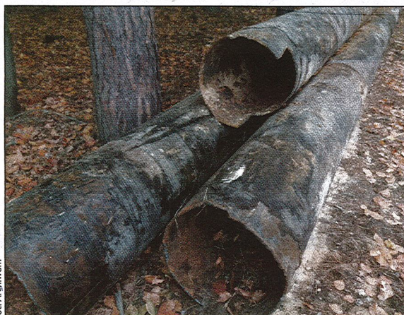
Wyeksploatowany i awaryjny stalowy rurociąg przesyłowy dostarczający wodę surową do SUW Strzyżewice
